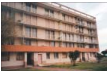
Réduction de la vulnérabilité structurelle par changement d'usage du rez-de-chaussée inondable
