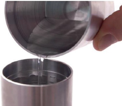
ပုံ (၈) - ရေနမူနာကို ၁၀၀ မီလီလီတာ လိုင်းသို့ ရောက်သည့် အထိ လောင်းထည့်ပါ။
