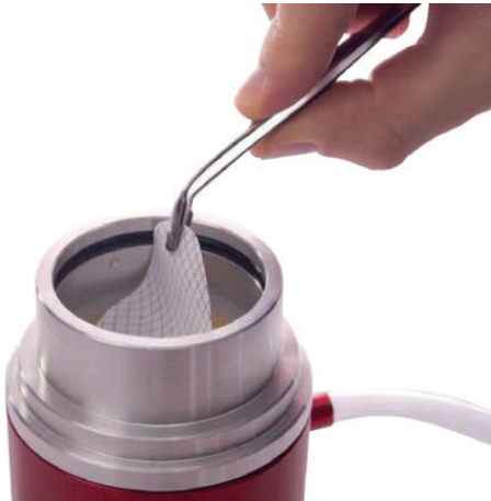
ပုံ - ၁၀ ရေစစ်ဘူးထဲမှာ အလွှာပါးကို ပိုးသတ်ထားသည့် ညှပ်သုံးပြီး ညှပ်ယူနေပုံ။
