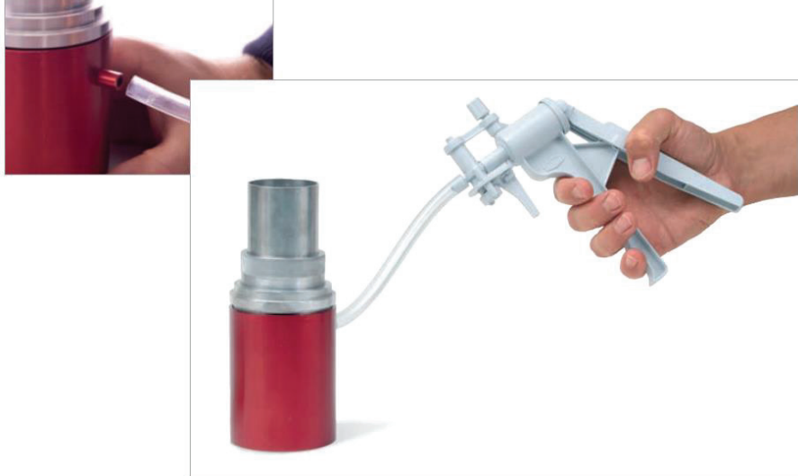
ပုံ - ၉ နမူနာရေများ membrane အလွှာသို့ ရောက်သွားအောင် လက်နှိပ်လေစုပ်စက်ကို နှိပ်ပေးပါ။
